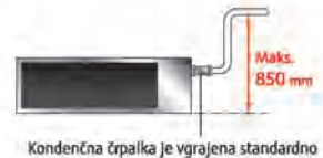
Kondenzna črpalka je vgrajena standardno
